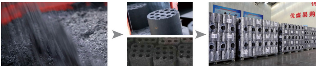
图 11：“灶薪”超市洁净蜂窝煤自动化生产工艺流程
